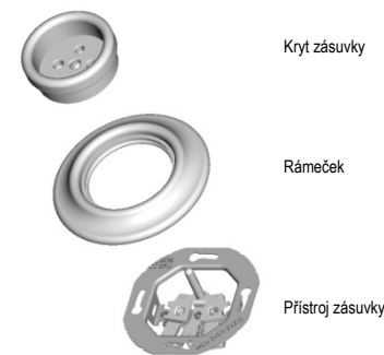
Obr. 4: Sestavování zásuvky s krytem a rámečkem
